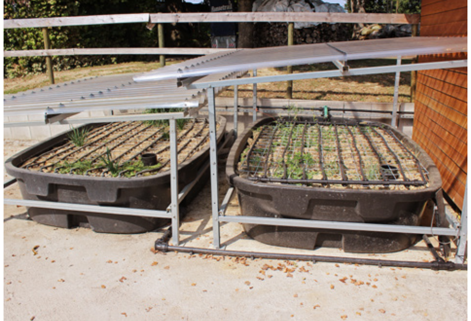
Die Phytobac-Anlage in Bavendorf verdunstet in ihren zwei Becken jährlich ca. 6.000 l pflanzenschutzmittel-belastetes Wasser.
