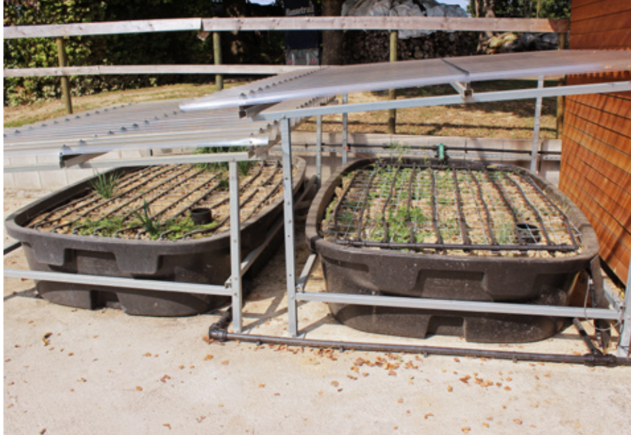
Die Phytobac-Anlage in Bavendorf verdunstet in ihren zwei Becken jährlich ca. 6.000 l pflanzenschutzmittel-belastetes Wasser.
