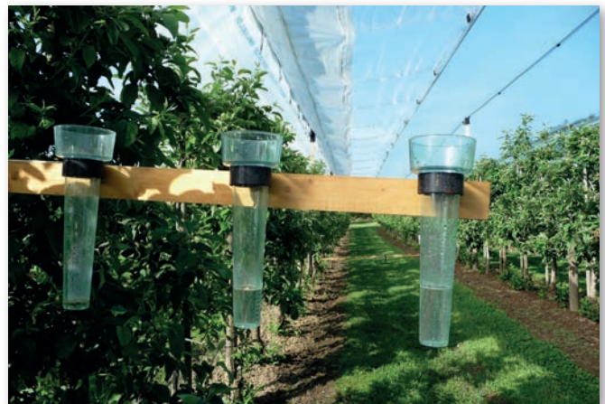
Deutlich sichtbar ist der Effekt auf die Niederschlagsverteilung unter der schmalen Folie. Dadurch konnte auch auf eine Bewässerung verzichtet werden
